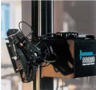
Le spectromètre installé sur la tête goniomètre pour les mesures de directivité.
