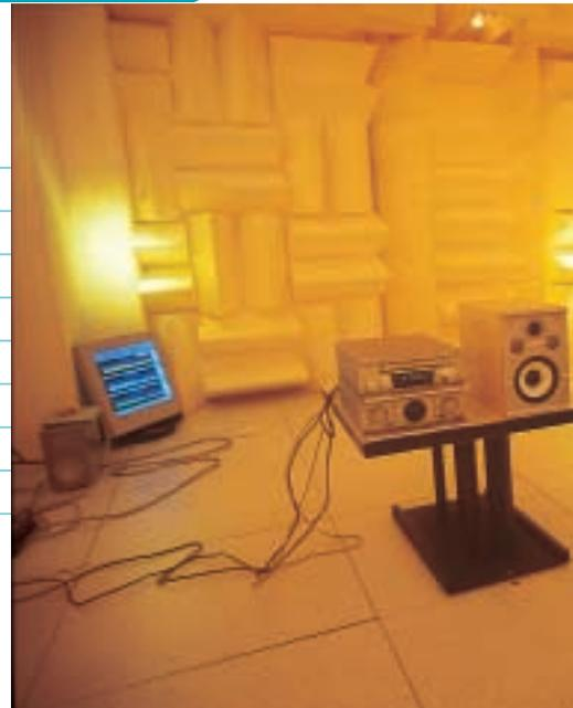
le niveau acoustique maxi à plusieurs fréquences. Dans le même temps, un accéléromètre nous permet de mesurer les vibrations des enceintes acoustiques. Tous ces éléments sont traités en temps réel grâce au système d'analyse Pulse de B & K, numéro 1 mondial de l'instrumentation de mesure acoustique.
