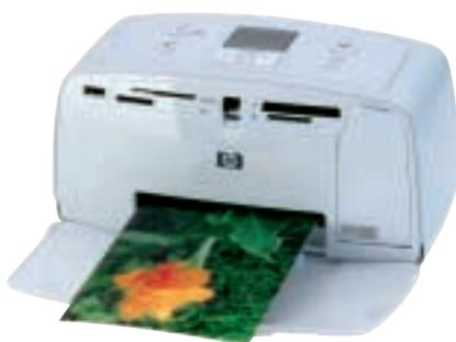
L'écran LCD de 3,8 cm et des touches de fonctions directes permettent la sélection, la suppression, l'impression ou l'aperçu des images. Des « slots » assurent la compatibilité avec les principaux types de cartes mémoire. Bonnes performances générales, en dépit d'un coût à la consommation grevé par des cartouches sous-remplies...
